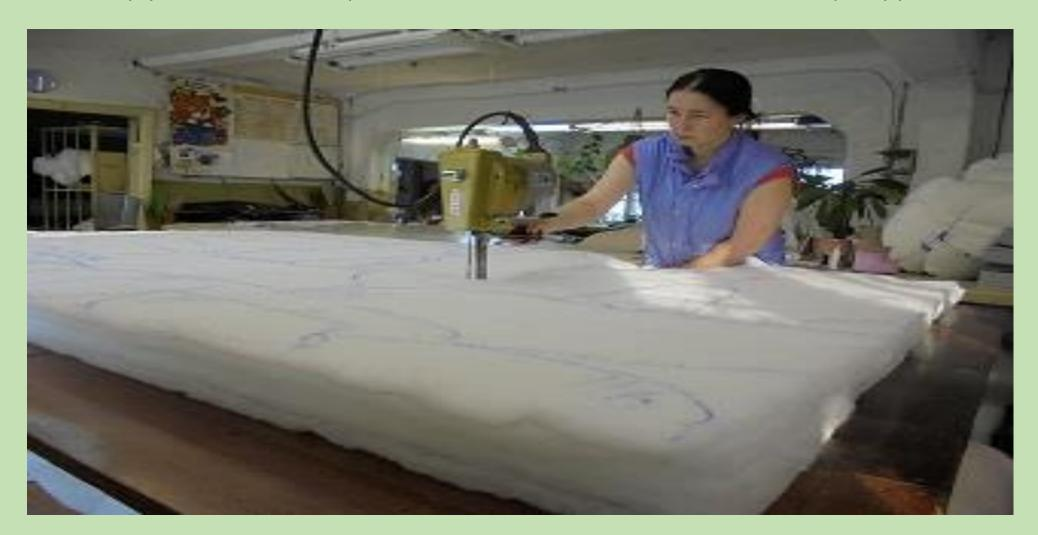
Такое раскройное оборудование используют для вырезания мелких деталей и деталей сложных конфигураций из предварительно рассеченных частей настила. Здесь работница делает осноровку деталей по лекалам из картона.
