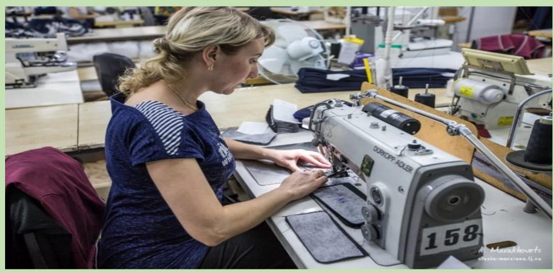
Заготовка клапана поступает швее, которая с помощью специального автомата пришивает его к другой заготовке. Лазерная линейка автомата позволяет расположить клапан очень ровно. Мгновение — и клапан на месте. Другая швея прорежет под ним ткань, сформировав тем самым карман.
